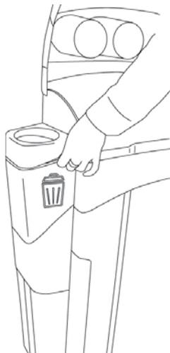
Retire la cubeta utilizando la pestaña en la parte delantera.
