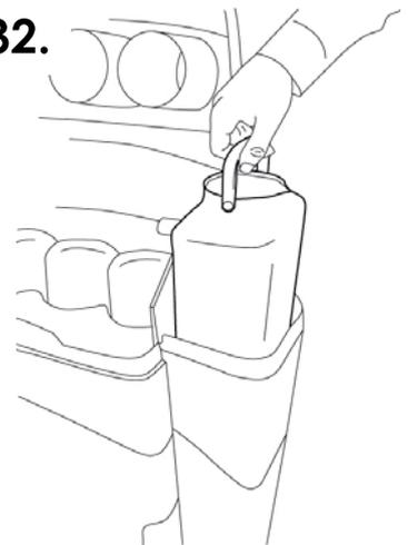
Utilizando el asa del depósito, sáquelo del contenedor lateral para vaciarlo.
