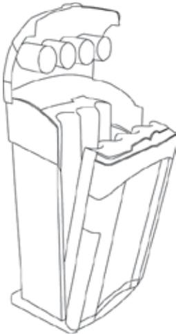
La puerta y la tapa permanecen en la posición de servicio, permitiendo el acceso los canales de apilamiento.
