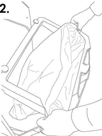
Una vez colocada la puerta en posición cerrada, sujete la bolsa a las pestañas de retención de la bolsa.
