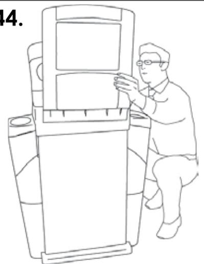
Alinee el kit de señalización con los 5 puntos de fijación de la unidad.
