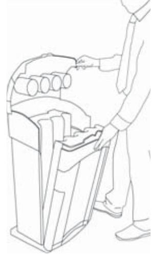
Tire de la puerta frontal hasta que quede en reposo en la posición abierta.
