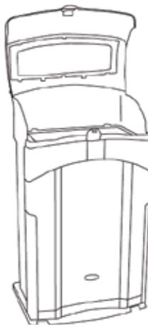
Coloque la tapa en posición vertical hasta que quede retenida por el sistema de sujeción.
